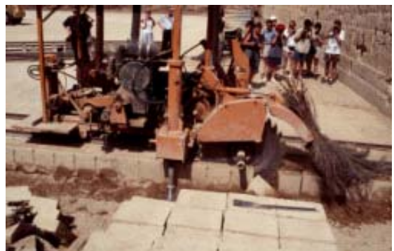
그림 10. 이탈리아 볼세나(Bolsena) 지방의 한 천연제올라이트 채석장에서 천연제올라이트 벽돌을 채취하는 장면.
